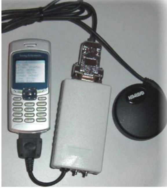
Şekil 2.8: GSM Telemetri Sistemi
